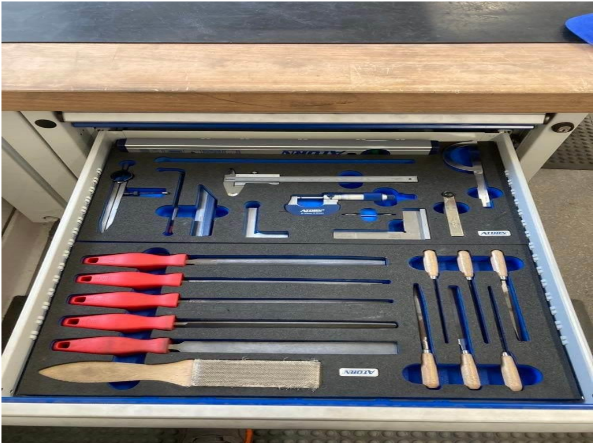
/különféle reszelők, szögmérő, tolómérő, derékszög, körző/
